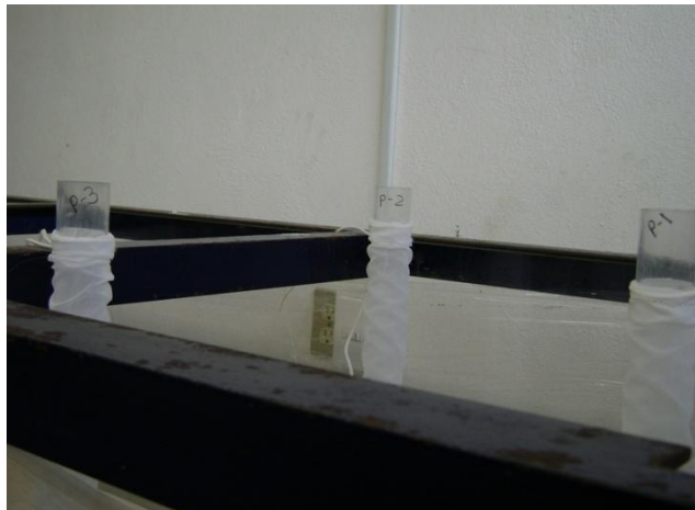
Figura 3.20 Pozos de monitoreo hincados en el modelo experimental
