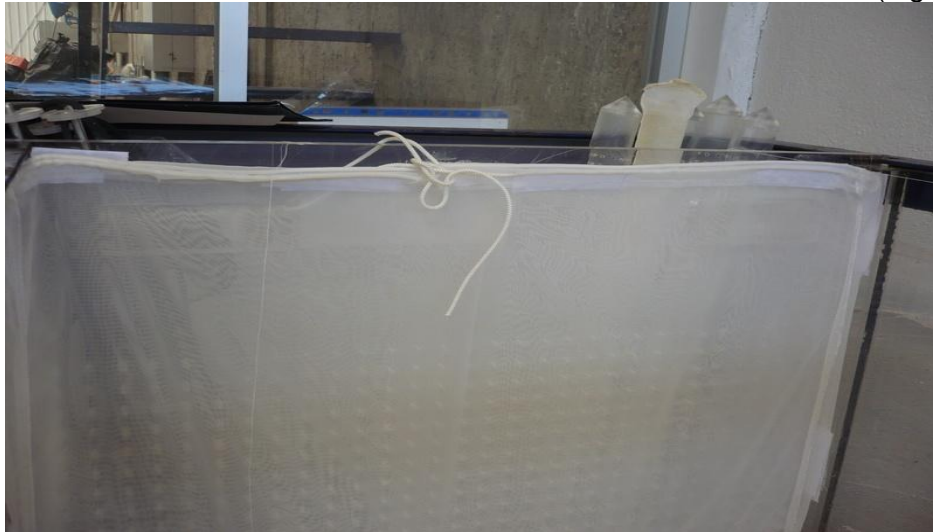
Figura 3.12 Filtro de paneles transversales
