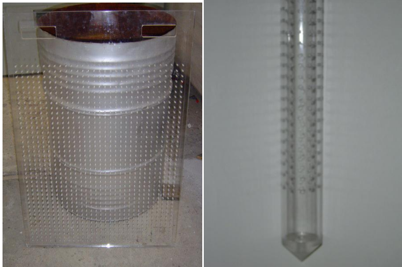
Figura 3.9 Lavado de paneles transversales y pozos de monitoreo
