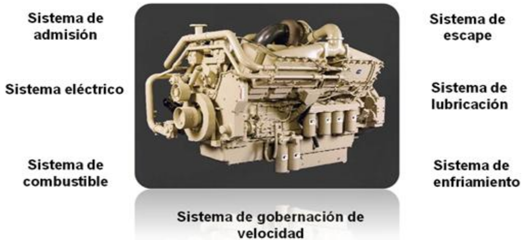
Figura 41 .- Sistemas principales del motor.
