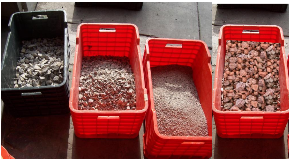
Figura 3.7 Material utilizado para la construcción del humedal
