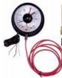
Figura. 3-8 Medidor de temperatura con zona.
