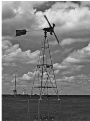
**Figura B.8** Cargador eólico de baterías.
