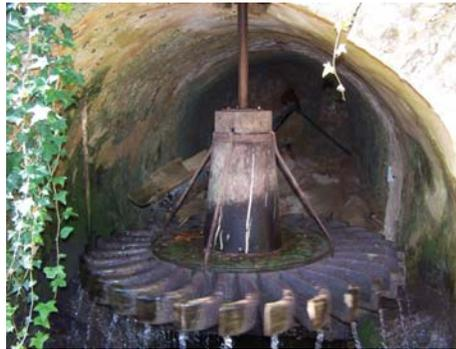
*Figura 1. Rueda Hidráulica Horizontal en “La Granja de Esporlas” Mallorca, España.
