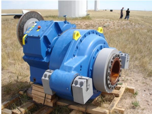
**Figura 2.8** Caja de engranes de una turbina eoloelectrica Vestas de 700 kW.
