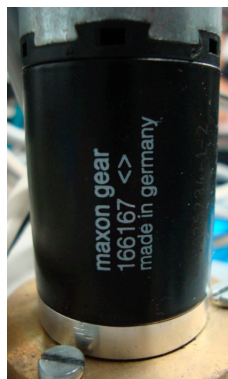
Figura 4.5: Caja de engranes GP 32 A
