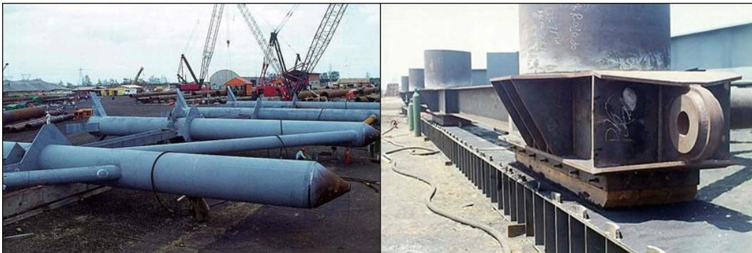
Ilustración 11. Columnas y "zapatos" de una superestructura
