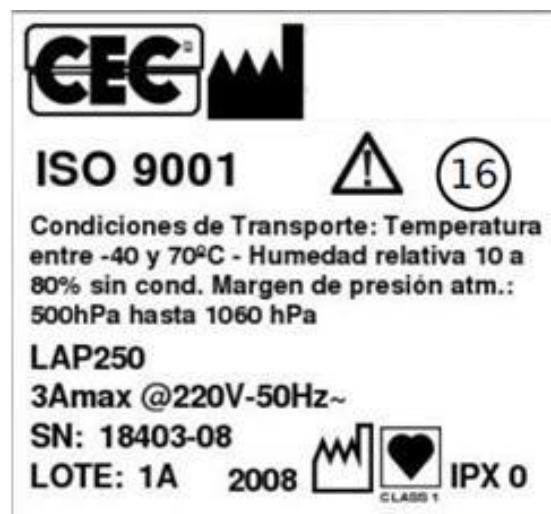
Figura 46. Ejemplo de placa de Certificación de Equipo Médico. Fuente: Manual de Operación: Electrobisturí LAP 250. CEC Electromedicina y Electroestática. http://www.cec.com.ar/
