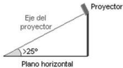
Figura 1.1 Altura de montaje de luminarias
