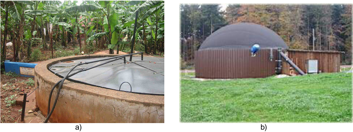
Figura 3.3 a) Digester hindú [6]. b) Digester con tanque de almacenamiento tradicional y cúpula de polietileno [5].
