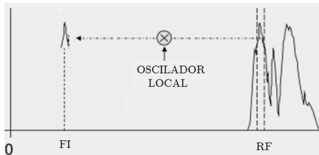
Fig. 1.1D Proceso de traslación de una señal de RF a frecuencia Intermedia.
