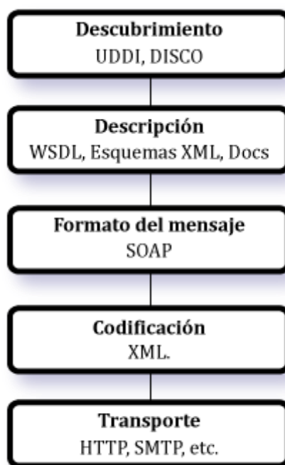
FIG. 19 BLOQUES DE CONSTRUCCIÓN BÁSICOS DE UN SERVICIO WEB
