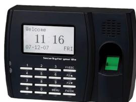
Figura 3.7: Lector de huellas digitales U300 de ZKSoftware
