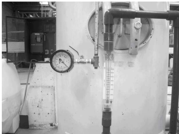
Figura 5.6. Sistema de medición neumático (rotámetro de flujo y placa de orificio).
