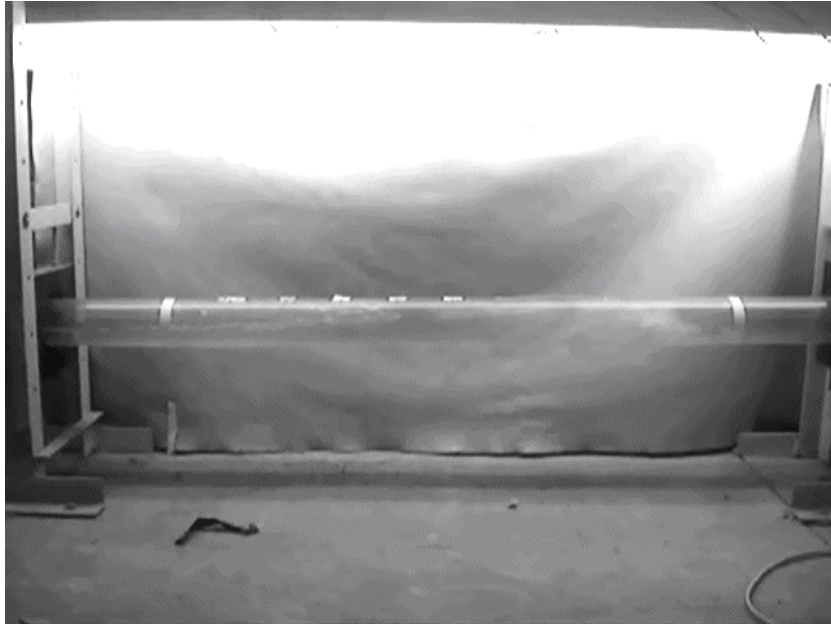
Figura 7.2. Imagen de un tapon hidrodinámico de 0.5 m de longitud (sección horizontal).
