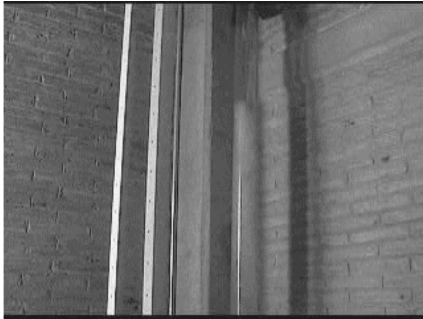
Figura 7.4. Imagen de un tapón largo en ascenso por el tramo vertical.
