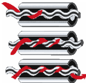
Fig. 5.78 Principio del funcionamiento del PCP.
