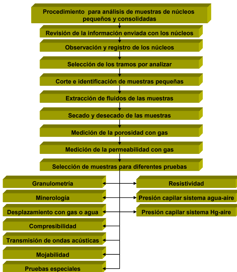
Fig. 5.13 Procedimiento de análisis de muestras de núcleos pequeños (formaciones consolidadas) 38 .
