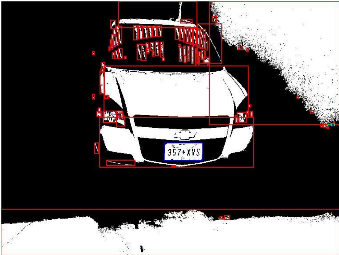
Imagen 6-25 Imagen binarizada, con la localización de la placa en azul.
