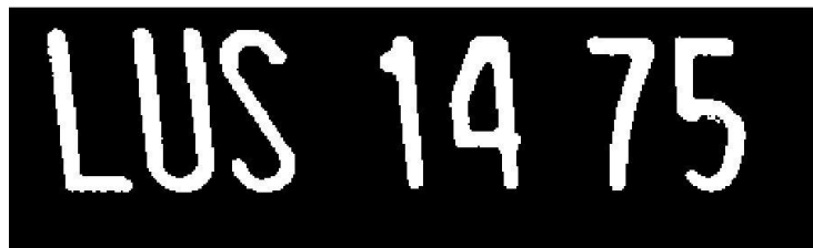
Imagen 6-45 6-46 SM binarizada con remoción de estructuras con área por debajo del discriminante.
