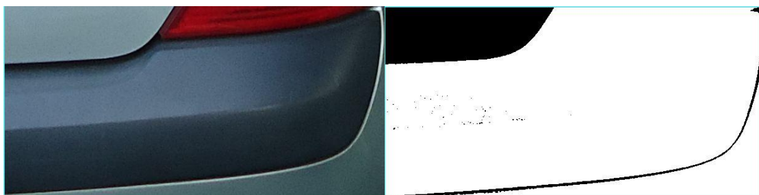
Imagen 6-35 Recorte del original y recorte de imagen binarizada.
