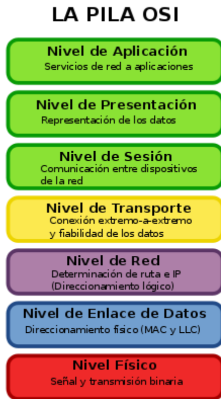
Figura 2.5 Capas del modelo OSI y función de cada una 22 .
