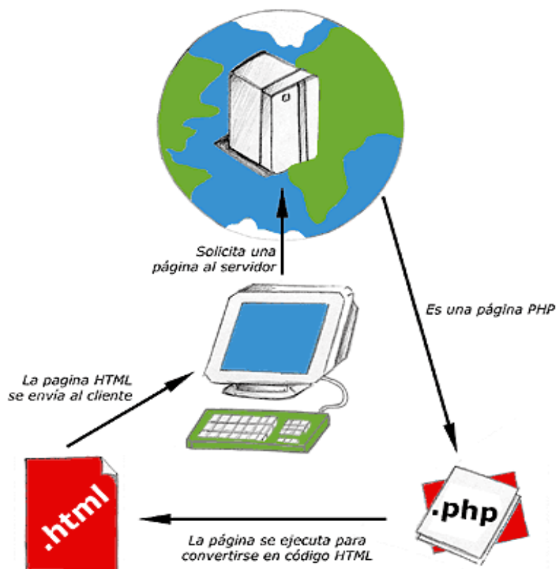
Figura 7.24 Funcionamiento de PHP.
