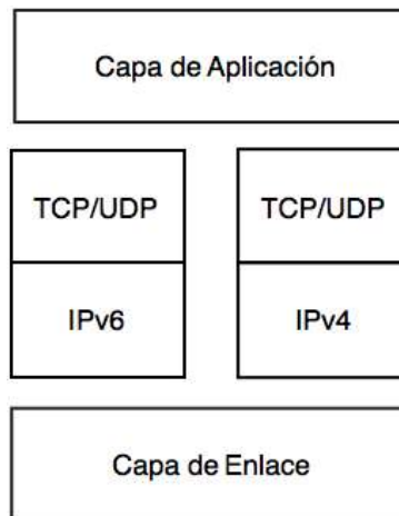
Figura 3.3 Arquitectura de pila dual
