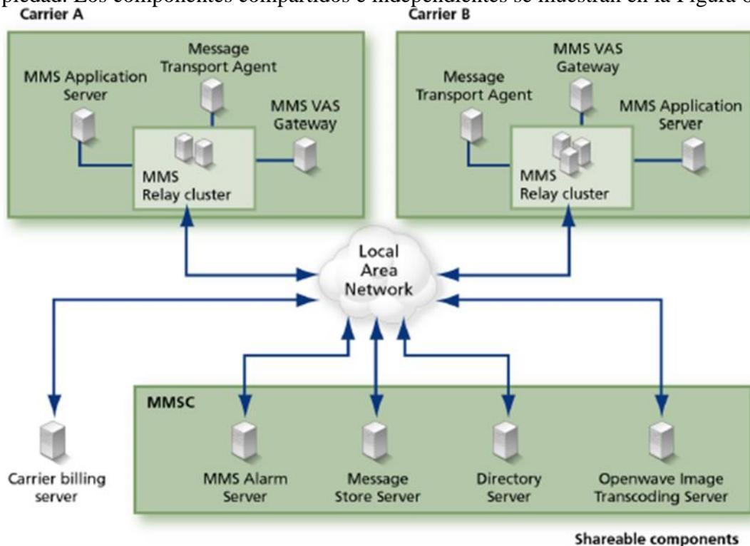
Figura 68. Componentes compartibles en una instalación multi proveedor.
