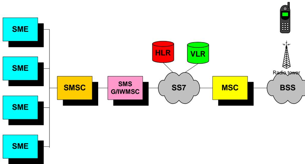
Figura 19. Elementos de red de un SMSC.
