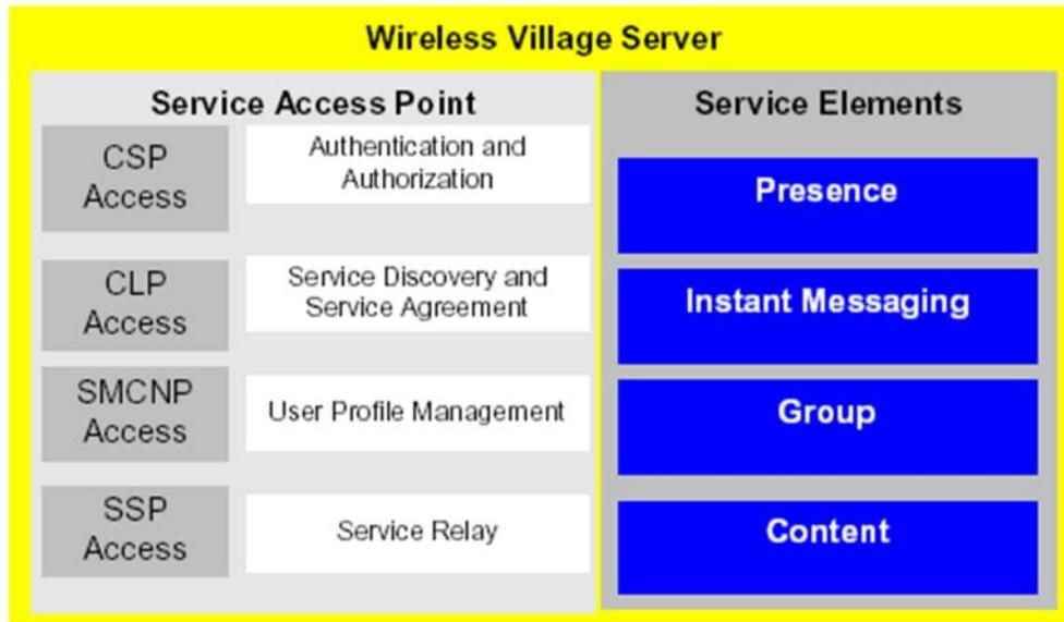
Figura 37. Elementos Funcionales de un servidor Wireless Village<sup>28</sup>.
