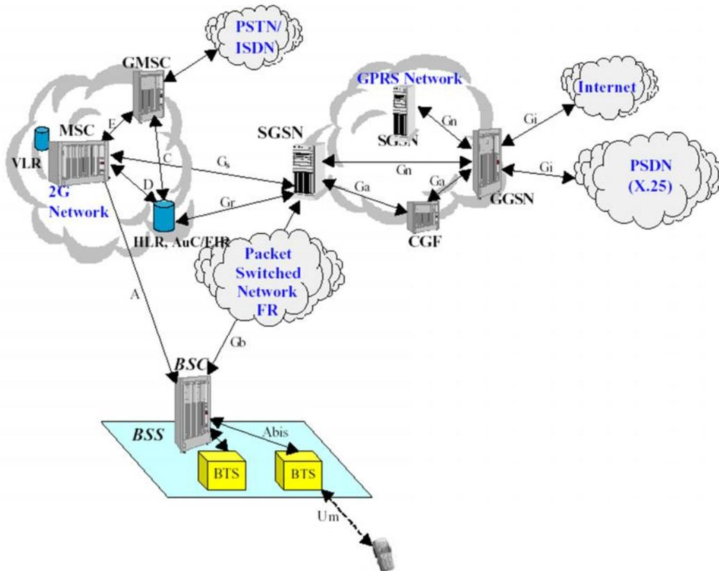
Figura 17. Red típica GPRS<sup>13</sup>
