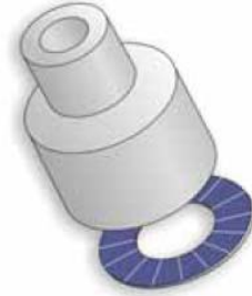
Figura 2.9. Diagrama de un arreglo anular con sectores
