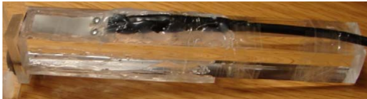
Figura 5.25. Transductor comercial con backing de acrílico.
