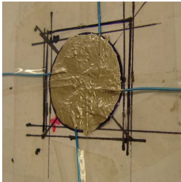
Figura 4.7. Arreglo de PVDF totalmente recubierto de Epoxy conductivo con terminales eléctricas.
