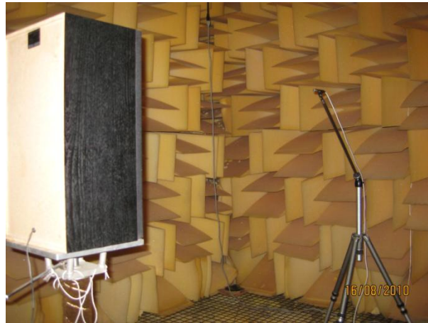
Figura 5.40: Cámara anecoica, CCADET.
