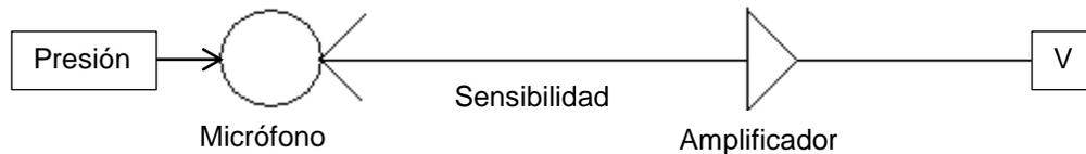
**Figura 1.7** Proceso de obtención del dBu y dBV.
