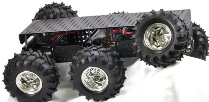
Figura 1.4 Configuración de Skid Steer
