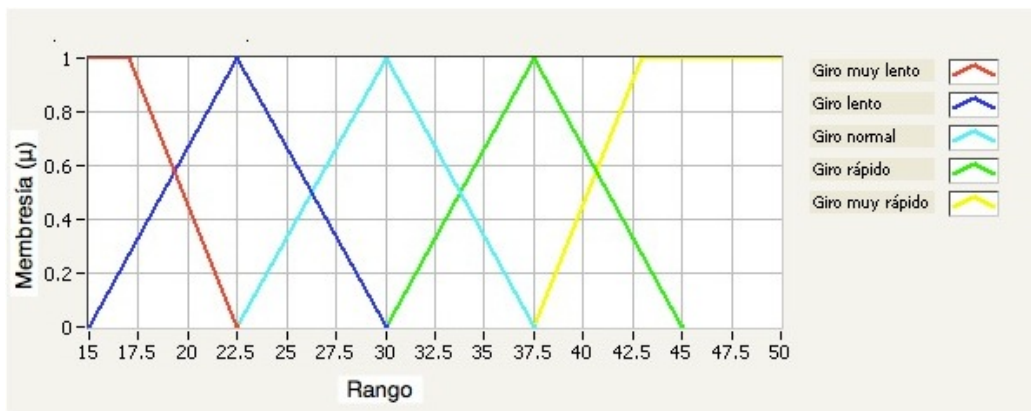
Figura 4.18 Variable de salida “giroMotoresOrigen”
