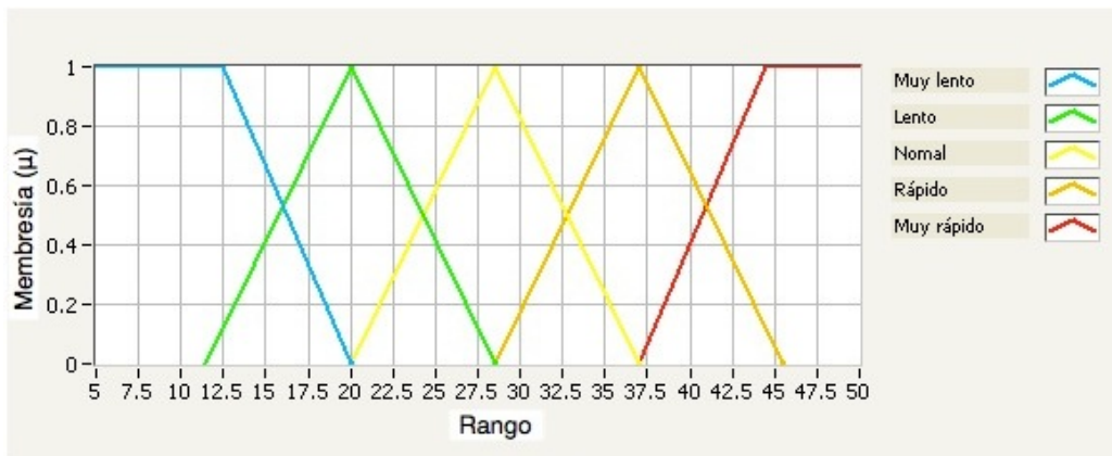
Figura 4.14 Variable de salida “ velocidadMotoresObjeto ”
