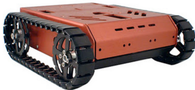
Figura 1.5 Configuración de Pistas de deslizamiento
