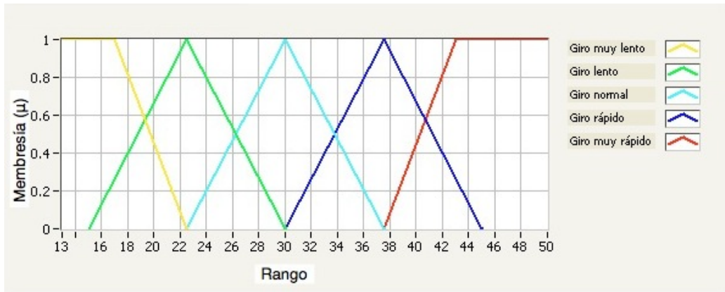
Figura 4.15 Variable de salida “giroMotoresObjeto”
