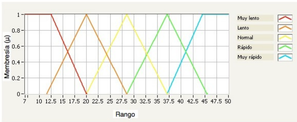
Figura 4.17 Variable de salida “velocidadMotoresOrigen”
