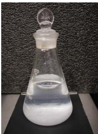
Figura 53. Mezcla de salmuera Abk 35 con el surfactante DS-10
