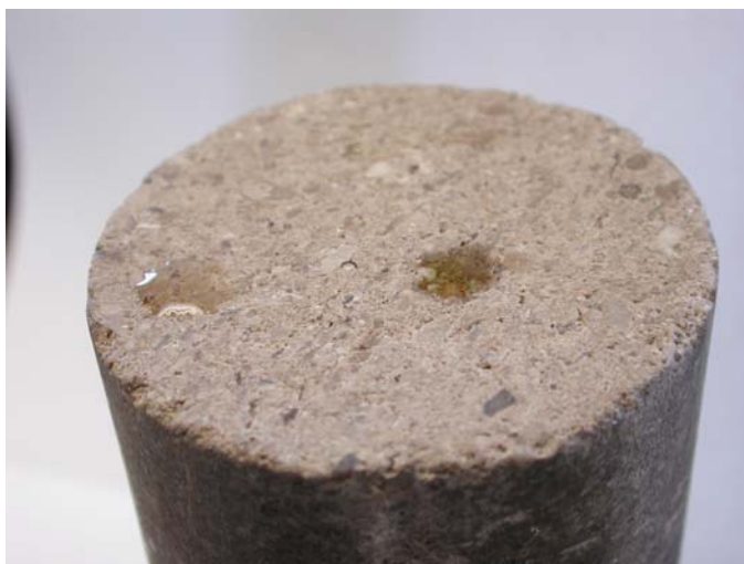
Figura 27. Prueba visual preliminar de mojabilidad. Núcleo I
