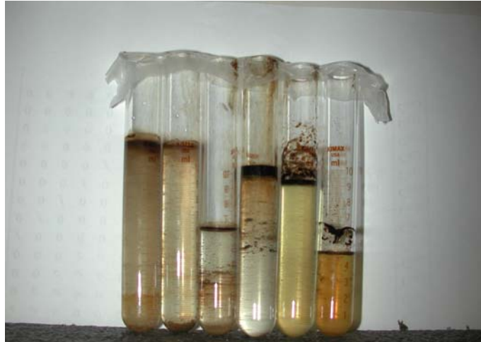
Figura 76. Fluidos desplazados por inyección de salmuera más surfactante SLS, segunda fase.
