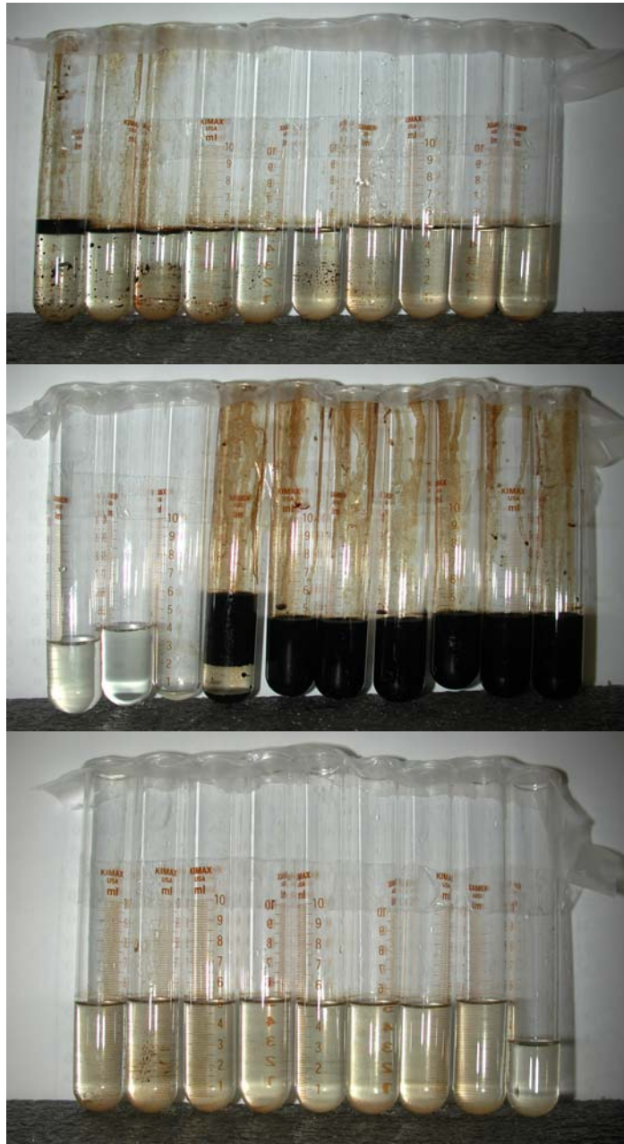
Figura 75. Fluidos desplazados por inyección de salmuera, segunda fase.
