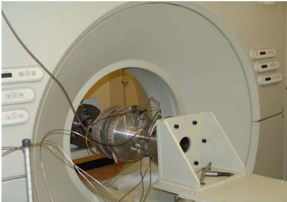
Figura 74. Celda circular montada en el tomógrafo conteniendo el núcleo II.
