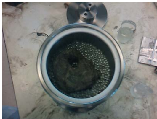
Figura 40. Núcleo Abk 7 en la celda de añejamiento previo a su limpieza
