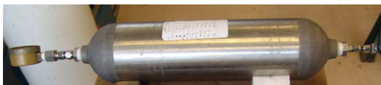
Figura 47. Bala conteniendo mezcla de gas a una presión de 1600 psia.
