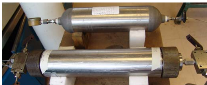
Figura 49. Foto del arreglo del traspaso de gas para la celda de recombinação.
