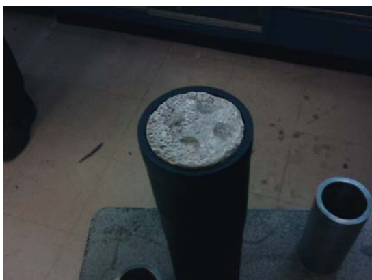
Figura 28. Núcleo enmangado para el confinamiento del Core Holder. IMP.
