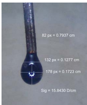
Figura B-1. Imagen de la gota de aceite en seno de N2 @ C.Y.
