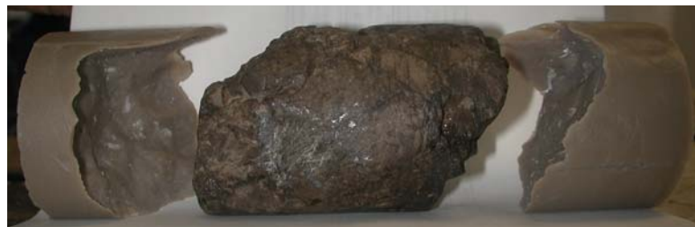
Figura 21. Núcleo Abk 7 con sus tapas de resina
