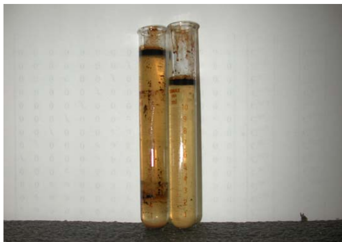
Figura 77. Fluidos desplazados por inyección de salmuera más surfactante SLS, posterior a un tiempo de reposo, segunda fase.
