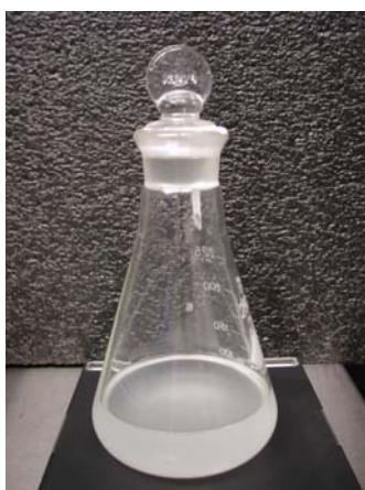
Figura 55. Mezcla de agua destilada mas salmuera con el surfactante SLS, medido a 80°C.
