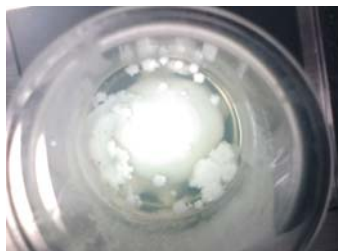
Figura 56. Presencia de micelas, mezcla de agua destilada mas salmuera con el surfactante SLS, medido a 80°C.
