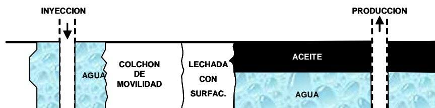
Figura 8. Desplazamiento con surfactantes. Shah y Schechter (4)
