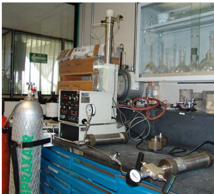
Figura 46. Foto del arreglo del traspaso del gas.
