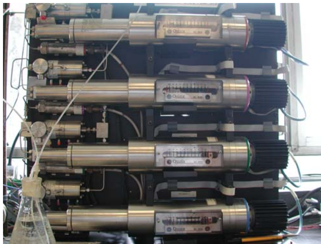
Figura 35. Bombas Quizix de desplazamiento continuo. IMP
