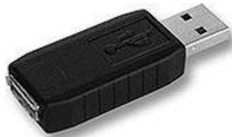
Figura 2.9 Adaptador USB para conexión de teclado de Keylogger
