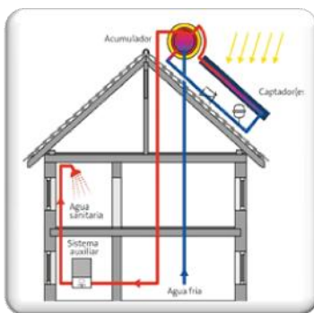
FIG. 2.8 MUESTRA DE LA INSTALACIÓN DE UN CALENTADOR SOLAR
