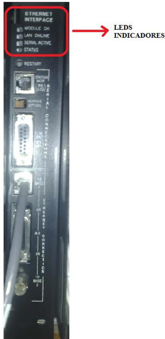
Figura 3.6 Módulo para comunicación Ethernet
