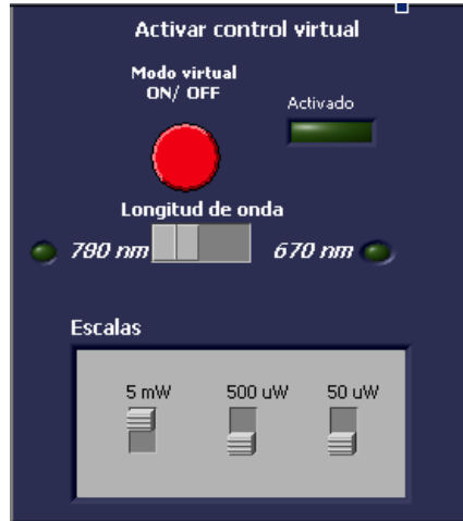
Figura 48. Controles que eligen longitud de onda y escala, y mandan, según el caso, la letra correspondiente de la “a” a la “f”
