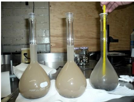
Figura 2. Vista del material usado para la prueba de densidad de sólidos en el laboratorio de mecánica de suelos. De lado derecho se observa la toma de lecturas de temperatura. De lado izquierdo las muestras a baño maría.
