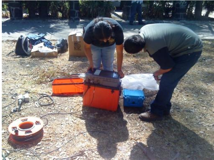
Figura 3.1. Equipo sísmico implementado para la sísmica de refracción, vista del modelo Strataview.
