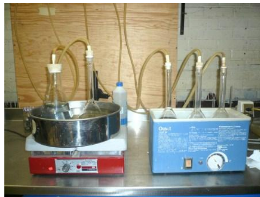
Figura 2. Vista del material usado para la prueba de densidad de sólidos en el laboratorio de mecánica de suelos. De lado derecho se observa la toma de lecturas de temperatura. De lado izquierdo las muestras a baño maría.
