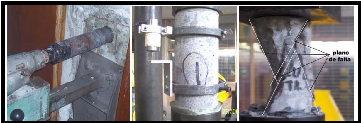
Figura 1.3. Extracción, preparación y prueba a compresión de un corazón de concreto.
