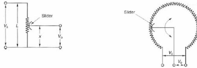
Figura 1.11. Potenciómetros lineal y angular (Aftab y Farhad 2004)
