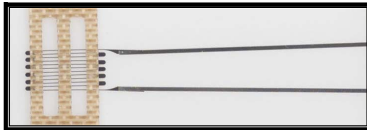
Figura 1.12. Galga extensométrica. (Aftab y Farhad 2004)
