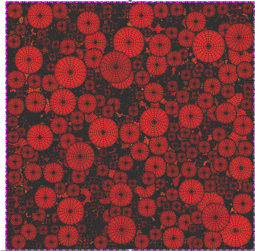
Figura A.11. Estructura tridimensional de granulometría continua, vista en planta
