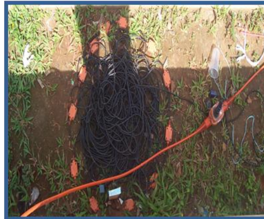
Fotos No. 24 y 25. Uso de Costales con Arena Sobre Geófonos para Minimizar el Ruido, Tendido en Zona Urbana.
