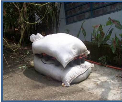
Fotos No. 24 y 25. Uso de Costales con Arena Sobre Geófonos para Minimizar el Ruido, Tendido en Zona Urbana.
