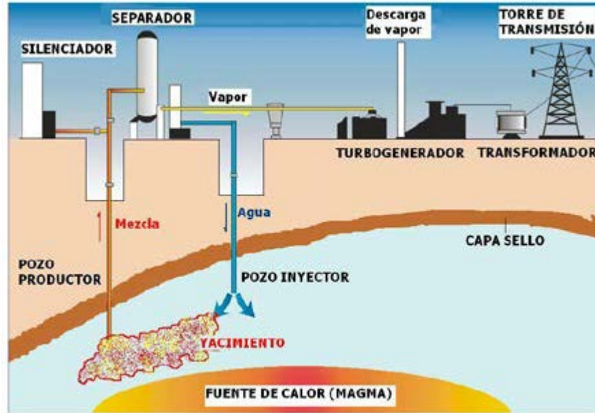
Figura 1.1 Modelo típico de un yacimiento geotérmico, su explotación sustentable, generación de energía eléctrica y conducción de ella a los centros de consumo. (Maya González y Gutiérrez Negrín, 2007).
