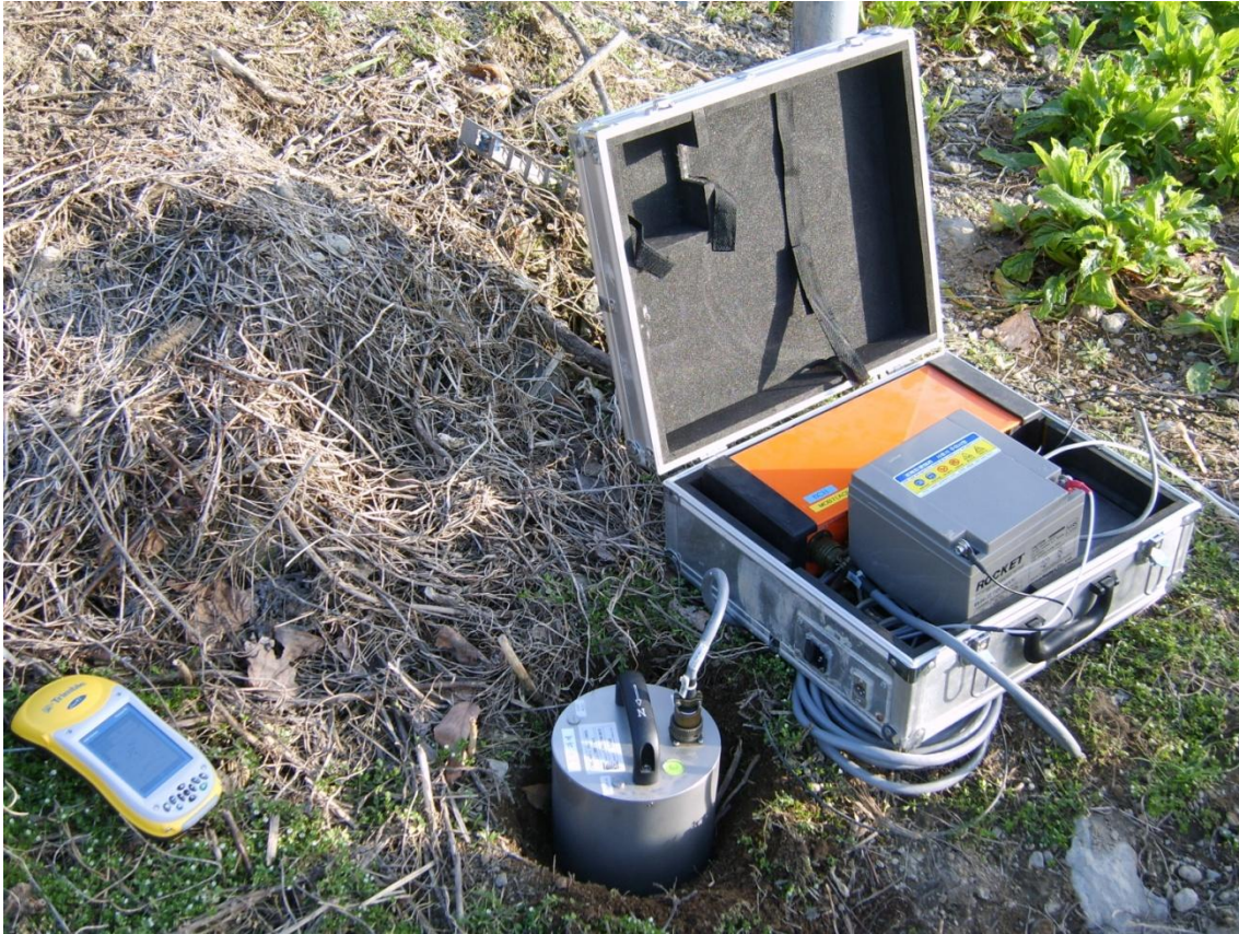
Figura 6. Equipo instalado temporalmente para el registro de ruido ambiental (correspondiente a la red de estaciones MT)
