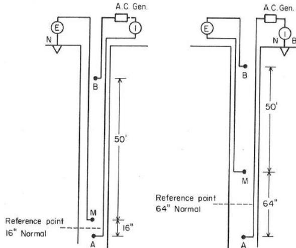
Fig. 49. Configuración del registro de resistividad normal corta y larga (Stefánsson & Steingrímsson, 1980).
