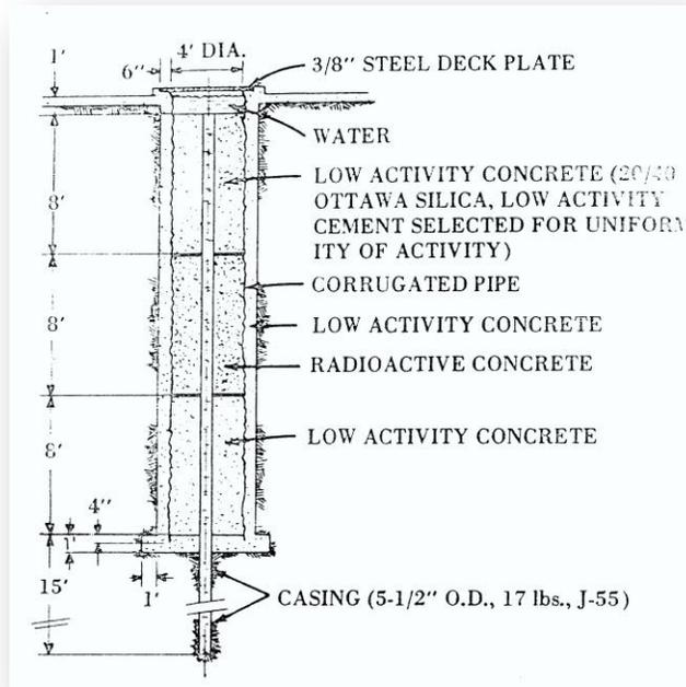
Fig. 46. Calibrador de rayos gamma propio del Instituto Americano del Petr3leo (API), pozo localizado en la Universidad de Texas en Houston. (Stef3nsson and Steingr3msson, 1990).
