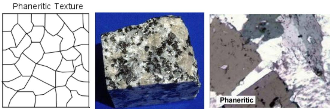
Fig. 5, 6 y 7. Textura fanerítica de las rocas ígneas, en diagrama, muestra de mano y lámina delgada, respectivamente. (Tomada de <http://faculty.chemeketa.edu/afrank1/rocks/igneous/texture.htm>, agosto 2011)
