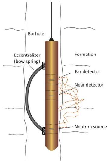
Fig. 47. Herramienta de registro de porosidad neutrón. (Steingrímsson, 2011).
