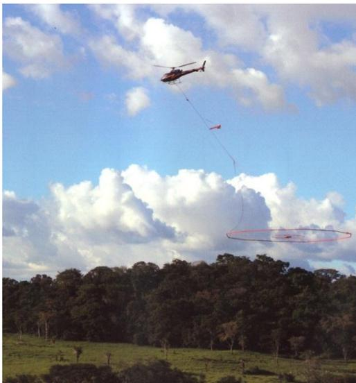
*Fig. 39. Levantamiento aéreo TEM.*
