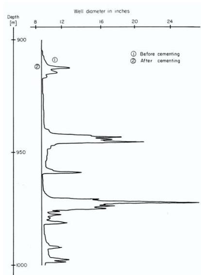
Fig. 44. Registro Caliper del pozo No. LN-12 localizado en Laugaland, Iceland. La curva 1 muestra las cavidades que presenta el pozo y la curva 2 muestra el diámetro del pozo entubado (Stefánsson & Steingrímsson, 1980).
