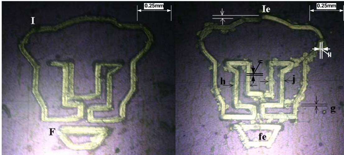
Figura 63. Maquinado continuo de un Puma de 1.2mm (izq), y Puma maquinado en espejo de 1.2mm (der).
