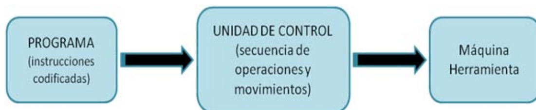
Figura 14. Componentes básicos de un CNC.
