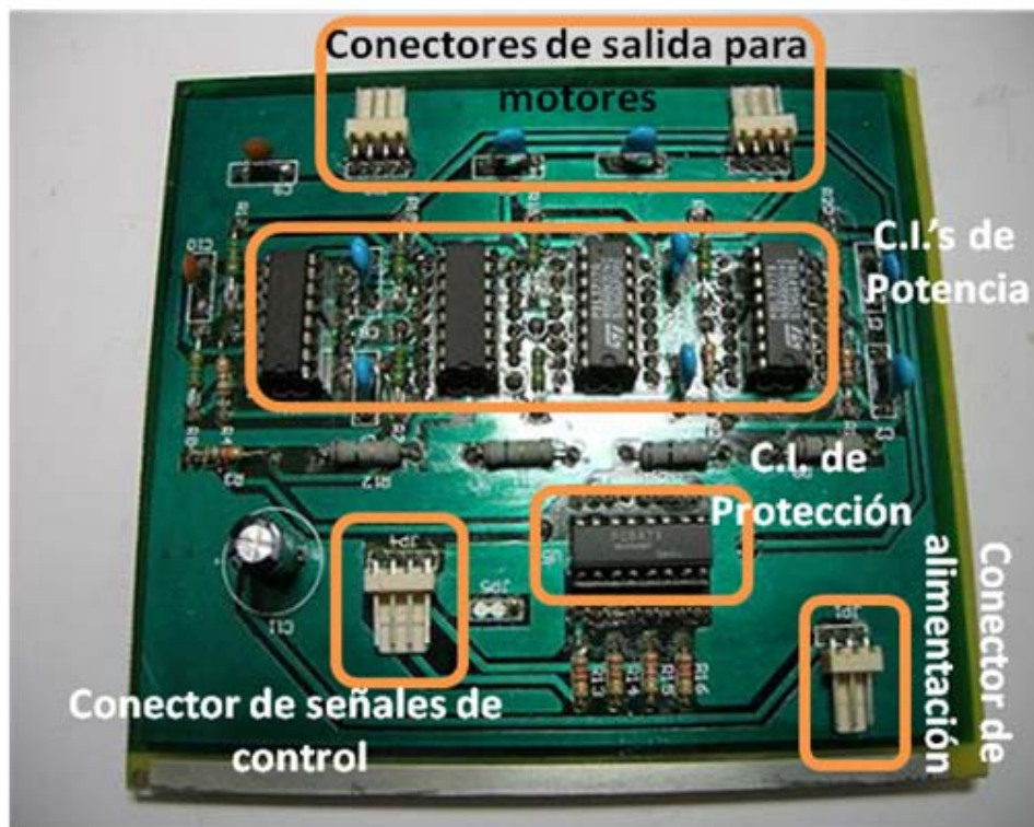
Figura 42. Sistema de potencia para dos actuadores de la MMH.
