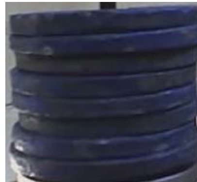
Foto 9 Carga en la ménsula del portapesas
