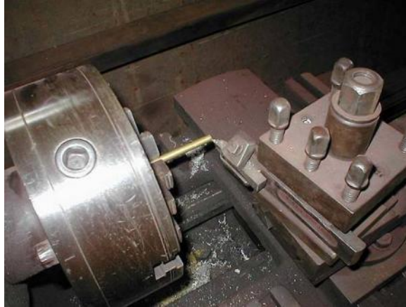
Figura 18. Desbaste del material en el torno.
