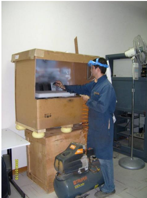
Figura 23. Cabina de pintado y equipo usado.
