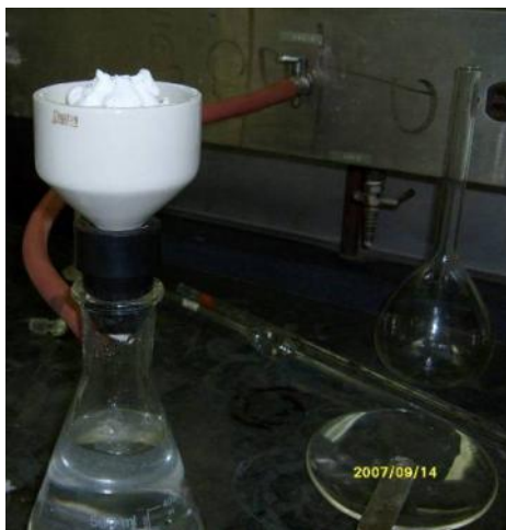
Figura 11. Embudo bucher filtrando fosfato de zinc.
