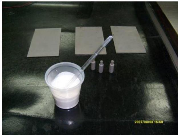
Figura 22. Incorporación del endurecedor de poliamida.
