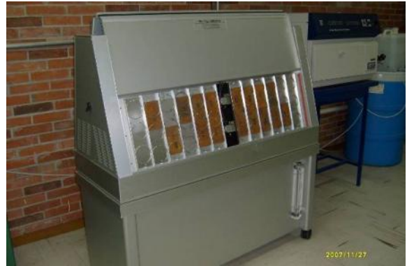
Figuras 27 y 28. Rociadores para el ciclo de lluvia y cámara de Intemperismo.
