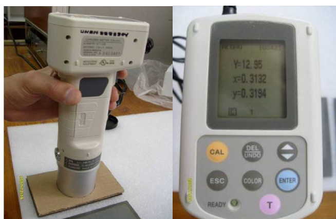
Figura 26. Uso del colorímetro y pantalla de lectura.
