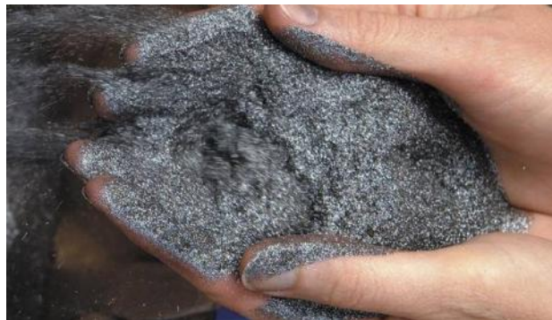
Figura 4. Óxido laminar de hierro, (Cortesía Mocayco ).
