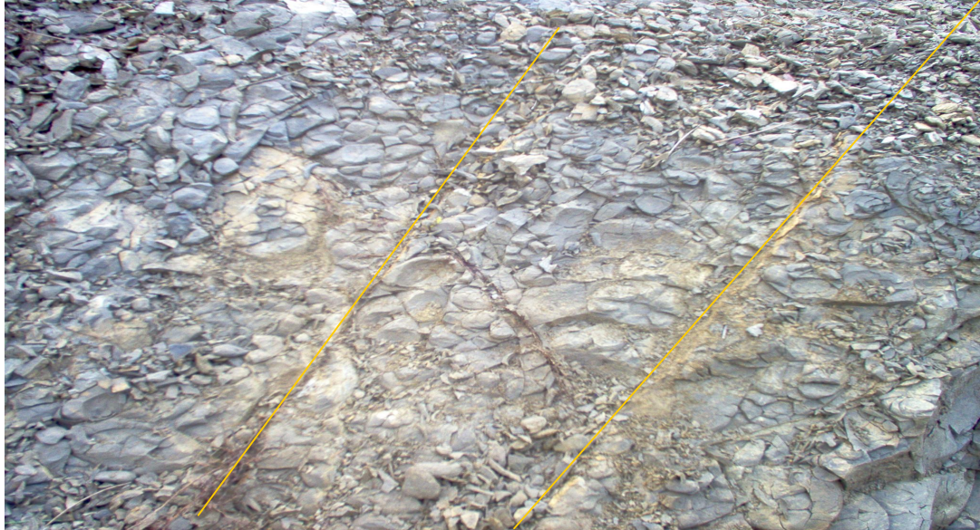
Fotografía 7.1.11. Se muestra el material denominado lutita, localizado en el camino hacia la presa “La Escondida”, a este material se le llama Choy, y también muestra una estratificación, así como la presencia de un anticlinal.
