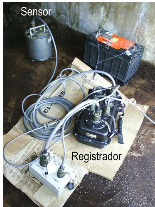
Figura 2.2: Estación sismológica de banda ancha (sismógrafo) portátil del SSN.
