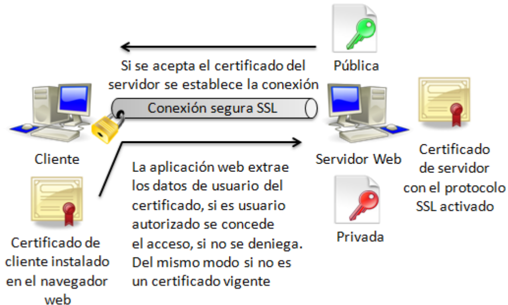
Figura 2.10 Autenticación mediante un certificado de cliente
