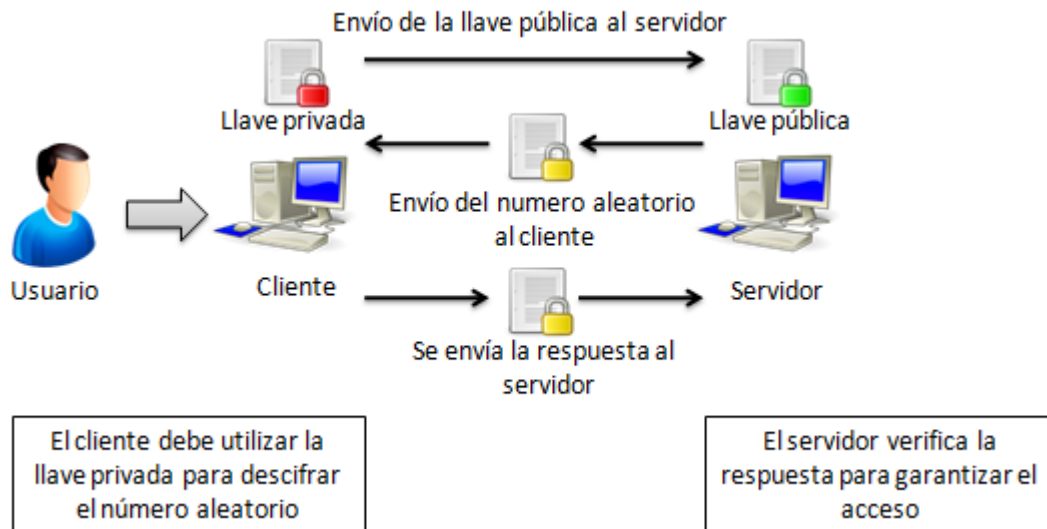
Figura 1.6 Procedimiento de autenticación mediante llave pública
