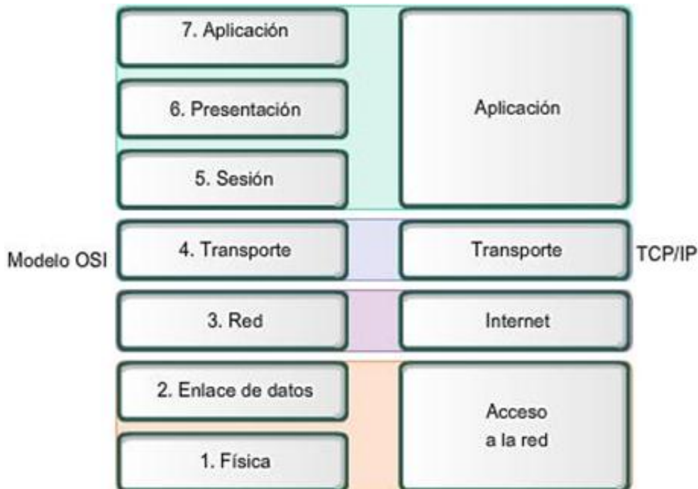
Figura 1.5 Comparación del modelo OSI y TCP/IP [2]
