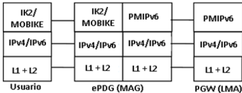
Figura 7.10 Estructura de PMIPv6 en interfaz S2b de SAE
