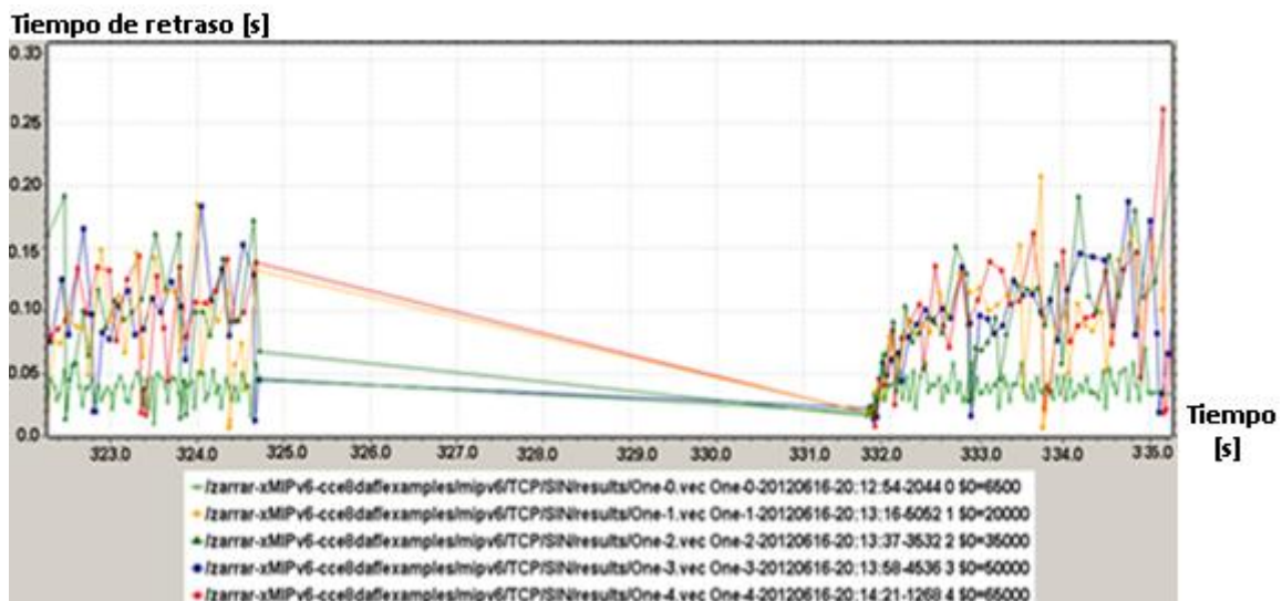
Figura 8.8 Tráfico TCP (MN-servidor)
