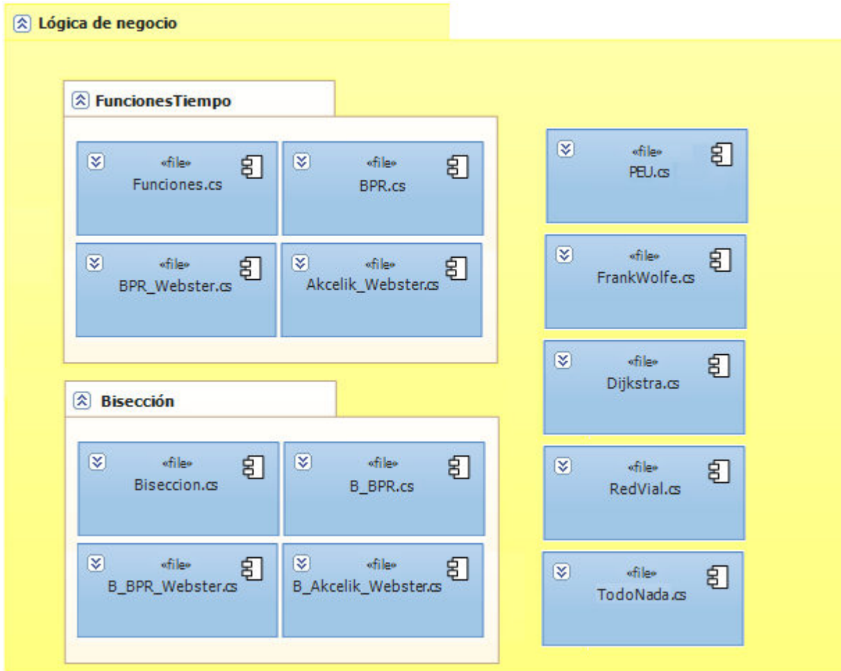
Figura 5.17 Paquete de lógica de negocio de la implementación del algoritmo que resuelve el PEU (Elaboración propia)
