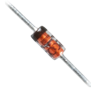
Figura 2-7. Diodo 1N4148 comúnmente utilizado como sensor de temperatura.
