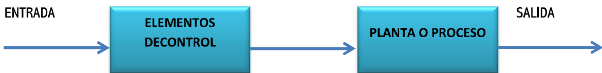
Figura 6-1. Sistema de control de lazo abierto.
