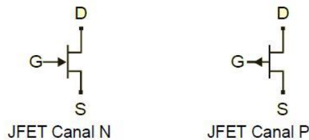
Figura 3-32. Símbolos esquemáticos para los JFETs de canal N y de canal P.
