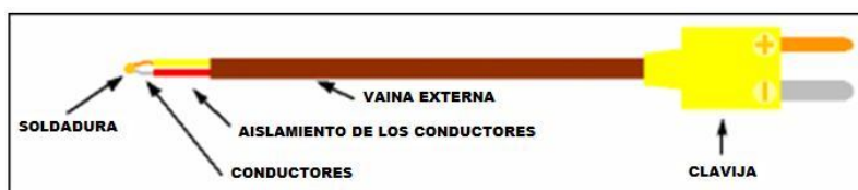
Figura 2-3. Partes que conforman a un termopar.
