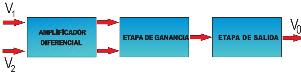
Figura 4-1. Etapas de la estructura interna de un amplificador operacional.
