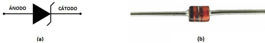
Figura 3-25. Símbolo del diodo Zener (a) y su imagen real (b).
