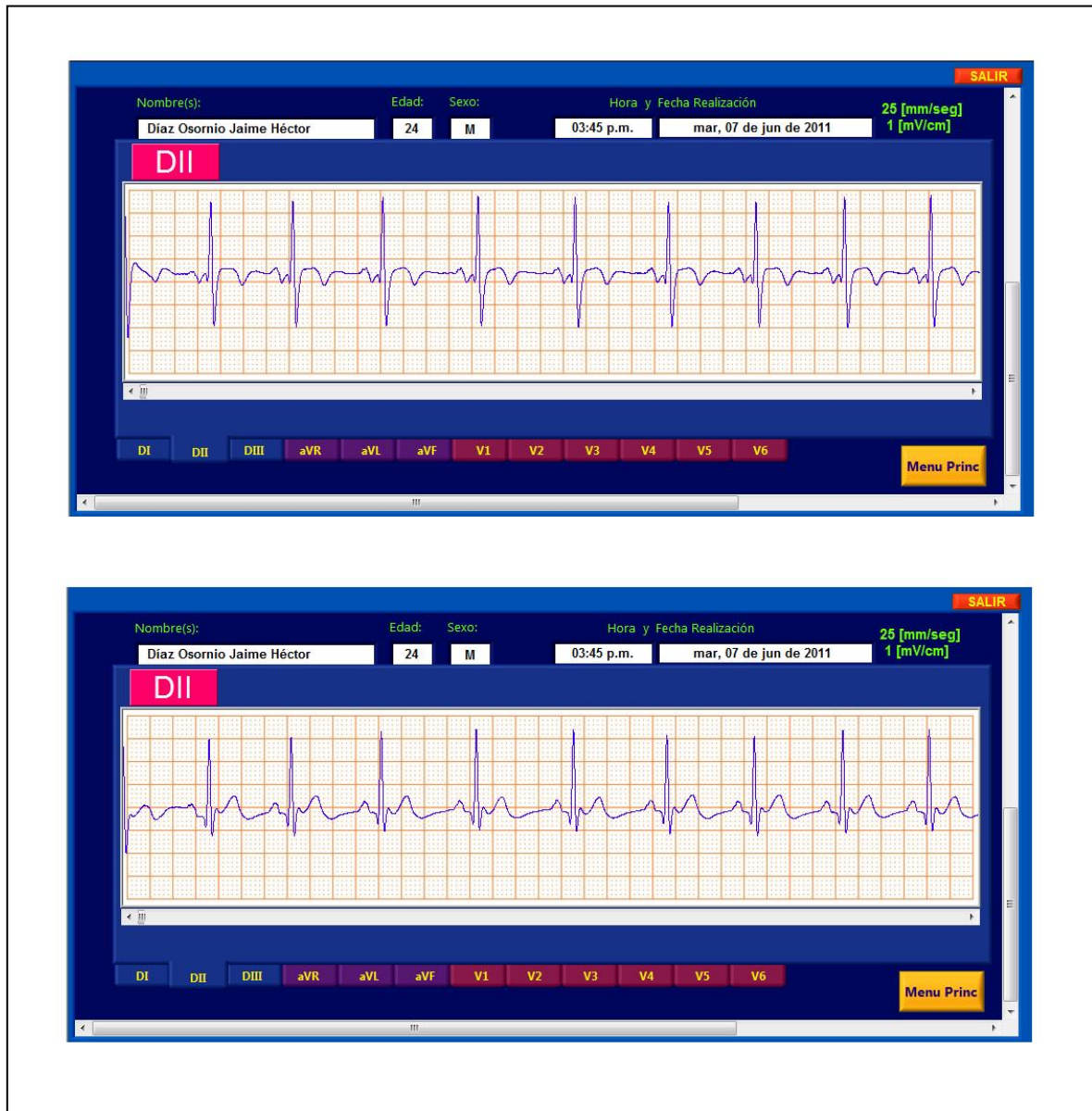
Figura 6.21 Comparativo de una misma derivación antes (parte superior) y después (parte inferior) de pasar por el programa Filtra.vi .
