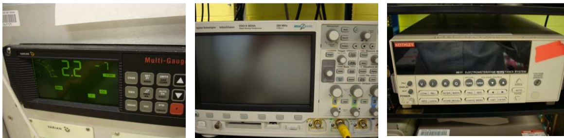
Figura 3.38 Presión a la que se encontraba la cámara de vacío, el osciloscopio Agilent DSO-X 3304A y el electrómetro Keithley.
