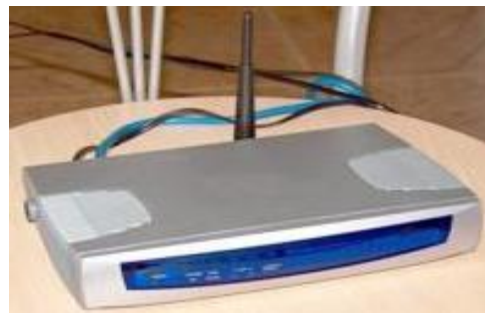
Figura 1.13 Punto de acceso inalámbrico
