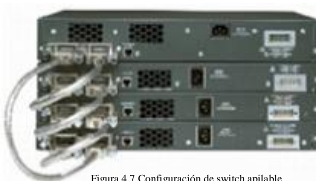
Figura 4.7 Configuración de switch apilable
