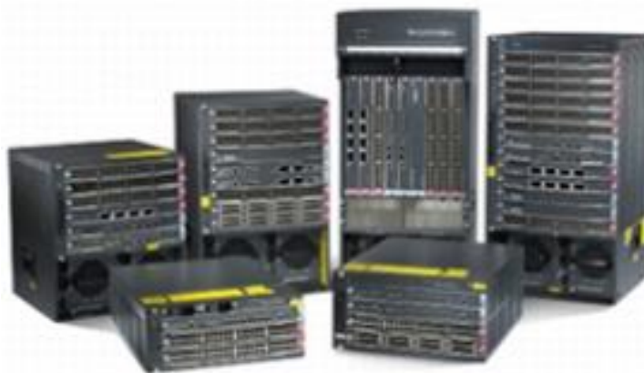
Figura 4.6 Switch con configuración modular
