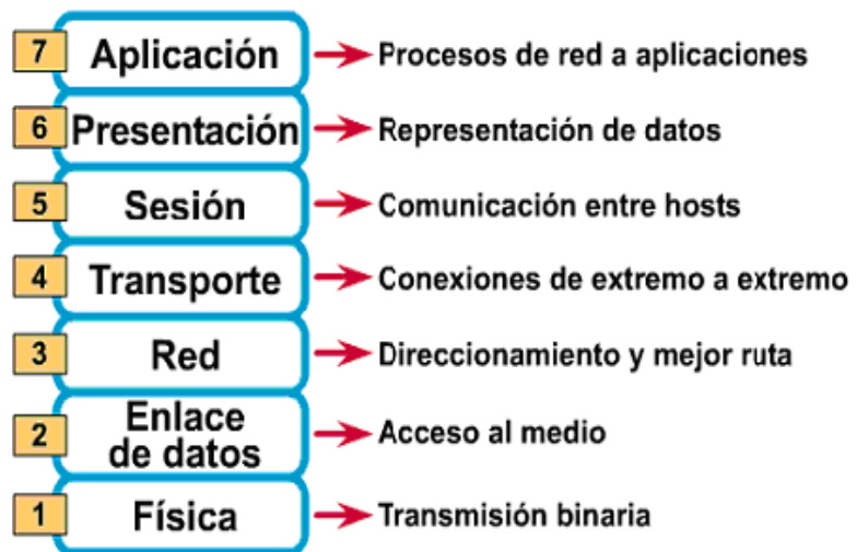
Figura 1.4 Funciones de las capas del modelo OSI
