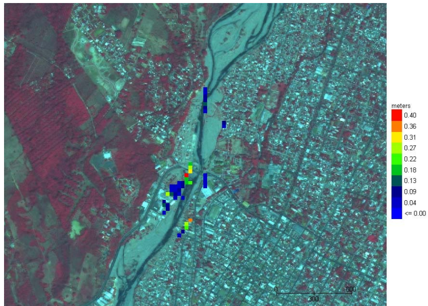
Figura I.15 Tirantes en las zonas donde el cauce es insuficiente con gasto de diseño
