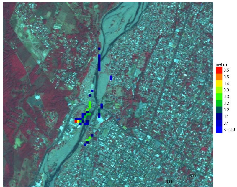
Figura I.18 Tirantes máximos fuera del cauce rectificado, gasto máximo con barras y escombros
