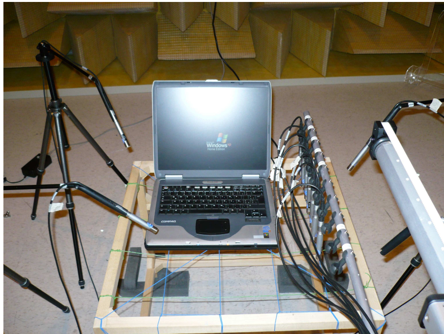
Fig. 8: Arreglo para la medición de intensidad por medio de holografía acústica.
