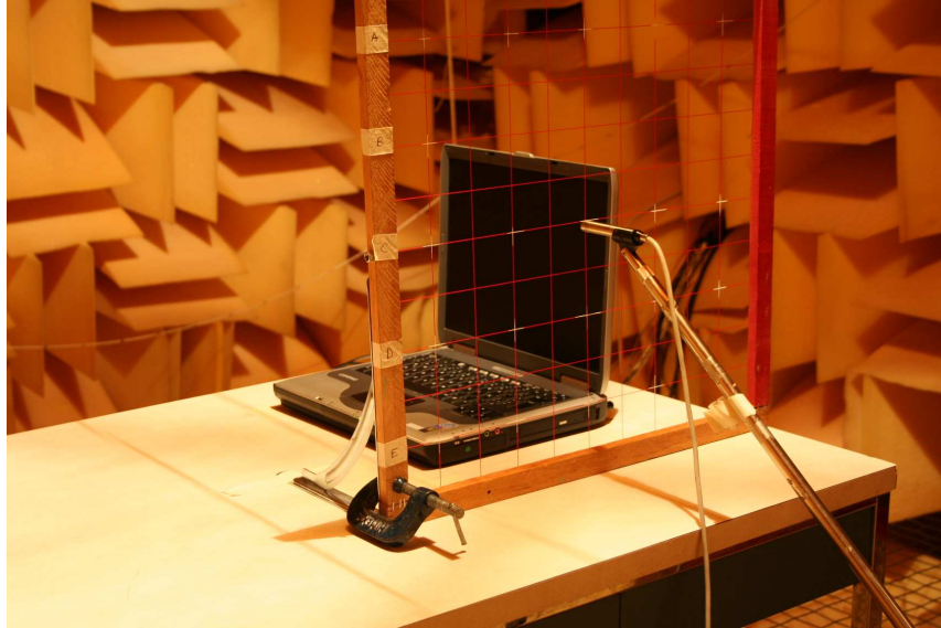
Fig. 1: Medición de espectros de presión sonora en la cara derecha R.
