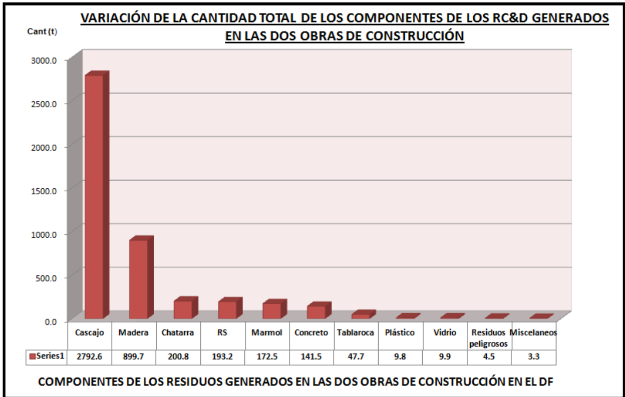
Figura 4.3: Diagrama de barras de la variación de la cantidad total de los componentes de los RC&D generados, como promedio de 2 obras de construcción.
